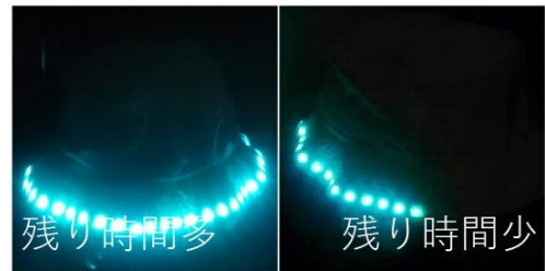
図 10 持ち時間によって光る様子 Fig. 10 Example patterns for remaining time
