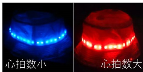
図 9 ジャッジの心拍数によって光る様子 Fig. 9 Example patterns for judge's heart-rate
