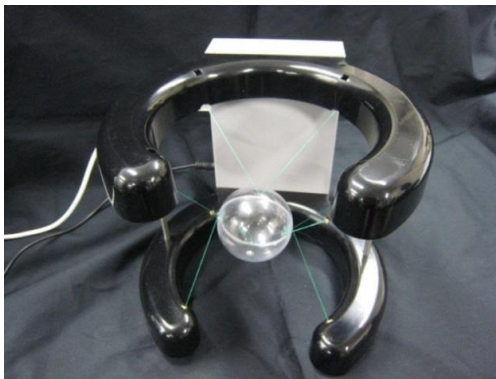
図 2 ワイヤ駆動型力覚提示装置 Figure 2 Wire driven haptic display
