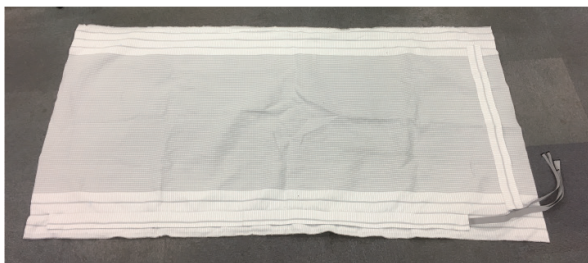
図 4 作成したシーツ型センサ Fig. 4 The sheet-type sensor we created
