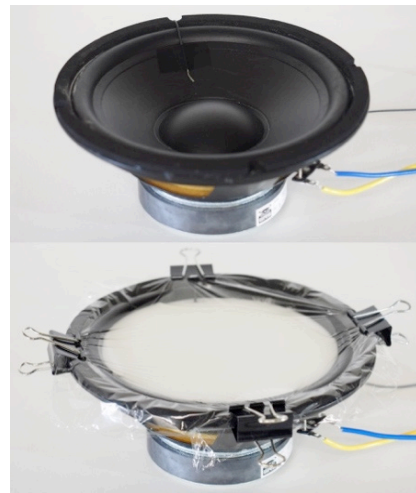
図2 流体を入れる前と後のスピーカーユニット Figure 2 Speaker unit before and after pouring fluid.
