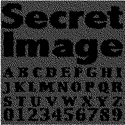
図 6 潜在化チェッカパターンキャリアスクリーン画像の復号結果
