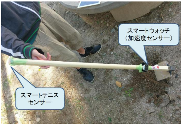
図 7: センサーを取り付けた鍬 Figure 7: Hoe with sensor attached
