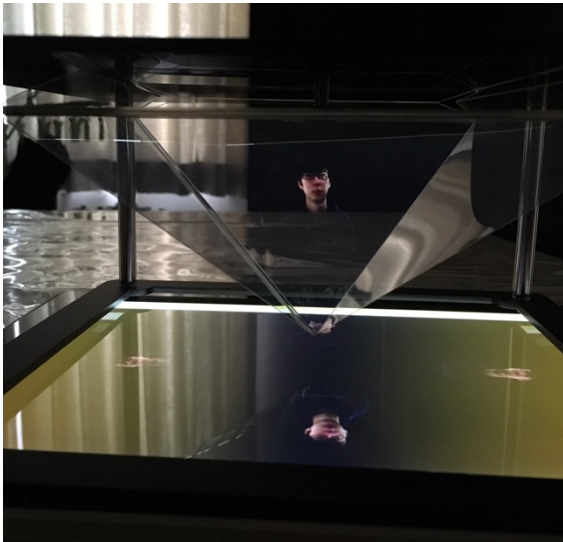
図 1 ペッパーズゴースト原理を用いたテレビ会議の様子 Figure 1 An Example of Videoconferencing with Pepper's ghost.
