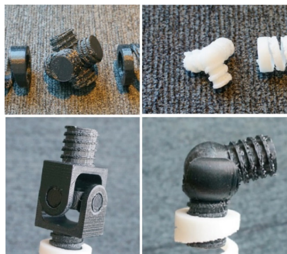
図 5 左上: 6 方向ジョイント, 右上: 三つ又ジョイント, 左下: ユニバーサルジョイント, 右下: ボールジョイント
