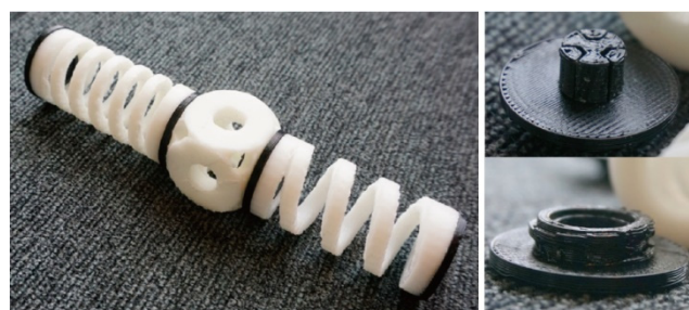
図 6 スナップ式ジョイント. ネジ接合をスナップ接合に変換するパーツを使ってコイルスプリングを接続する.
