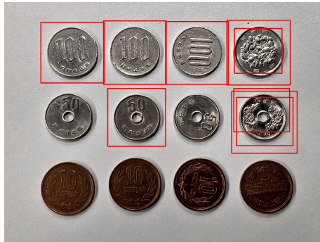
図 13 検出基準 4 (DoG と色) を使って硬貨を類似物体検出した結果
