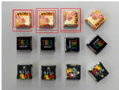
図 14 検出基準 4 (DoG と色) を使って食品を類似物体検出した結果
