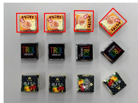
図 12 検出基準 3 (SIFT と色) を使って食品を類似物体検出した結果
