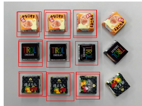
図 10 検出基準 2 (DoG) を使って食品を類似物体検出した結果
