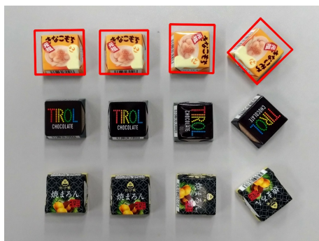
図 8 検出基準 1 (SIFT) を使って食品を類似物体検出した結果
