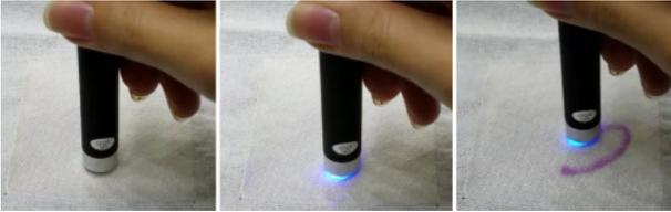
図 14 レーザーポインタでキャンバスに描画する一連の動作。描画開始時点でレーザー照射を開始し、照射したまま動かすとレーザーの軌跡が発色し、線画となる。
