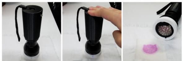
図 18 スタンプ描画の一連の動作。UV スタンプライトをキャンバスに押し付け（図左）、持ち手を押下して最後まで押し込む（図中）。UV ライトを離すと、型の穴の形に発色した絵が残りスタンプ完成（図右）。
