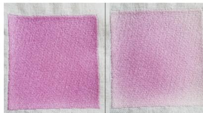
図8 紫外線照射機にあてたもの(左)と手持ちUVライトであてたもの(右). 照射時間は5秒.
