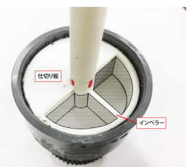
図 5 すりぎりの機構
