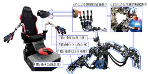
図4 視覚ベース操作インターフェース (技術検証機)
