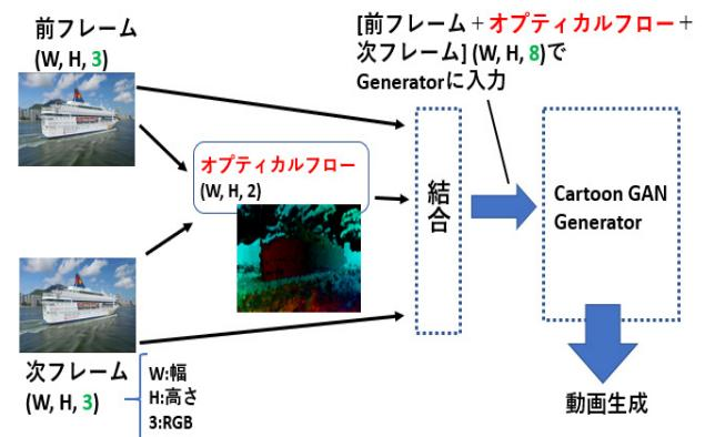
図3. 本実験でのモデル構成
