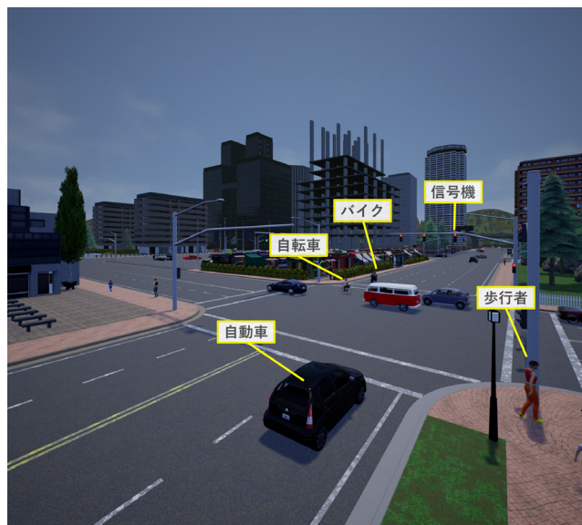
図 4 本研究で用いる走行環境. 予め定義したシナリオに従って、歩行者や車両を指定したタイミングで配置し、制御することで、走行環境を実現する。
