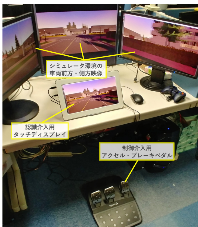
図 5 本研究で用いる実験環境。正面のディスプレイはシミュレータ環境を被験者に提示するための車両の前方映像、左右のディスプレイは車両側方映像を映し出す。手前のタッチディスプレイを認識介入時の被験者とのインタラクションに用いる。被験者の足元に設置するブレーキ・アクセルペダルで、認識介入との比較として制御介入時に車両の速度制御を行う。
