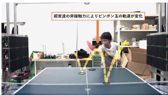
図 5 超音波による変化球を受けたプレイヤーの実際のミス (空振り) の様子。オレンジ色のラインは実際に撮影したプレイ動画の各フレームからピンポン玉を抽出し、重ねることで生成した。ただし、変化が無い場合の軌道 (黒い点線) 及び軌道変化のタイミングは、動画より目で見て判断し記入している。
