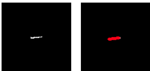
(a) 二値画像に変換した LiDAR のスキャン結果 (b) 確率的ハフ変換による線分検出
