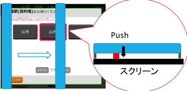
図 2: タッチレス操作デバイスのモデル
