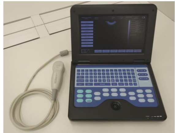
図5. 超音波映像装置(CMS600P2)とコンベックス走査型探触子(Micro-Convex Cardiac Probe)。
