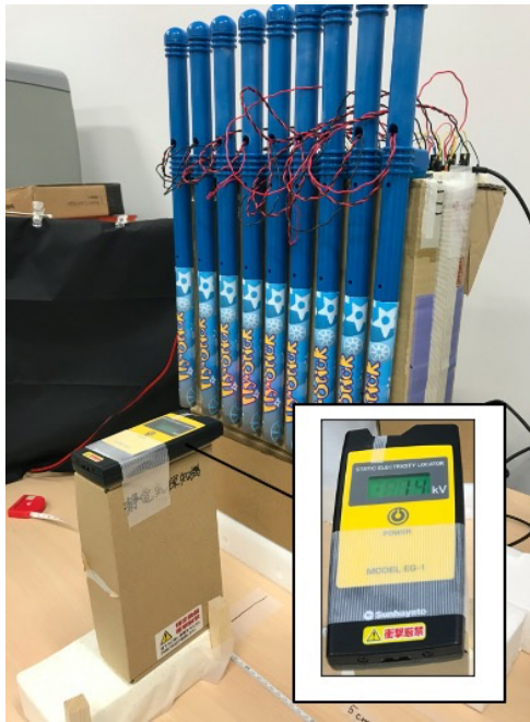
図 4 帯電電位測定の様子
