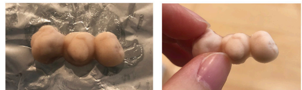
図3 HARIBOを融解させて利用した実験結果。形状にばらつきが生じてしまいやすかったり、正確な造形が困難であった。
