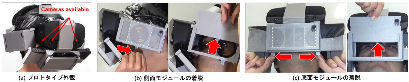
図 3: プロトタイプの外観と各モジュールの着脱機構。((b)(c) の点線で囲まれた範囲は、実際には遮蔽されている)
