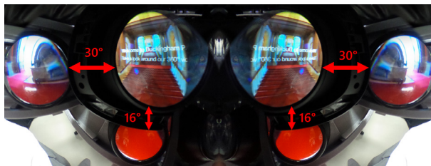
図 4: プロトタイプの内部構造 (単眼カメラによる撮影の都合上、左目視点で撮影した画像を左右反転させて結合した絵)
