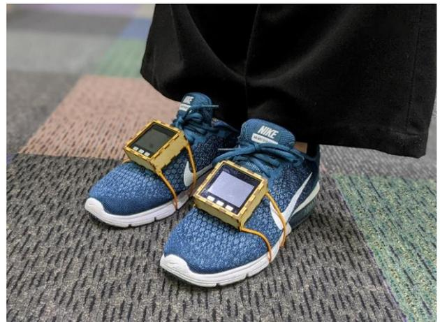
図 10 M5Stack Gray を取り付けした靴
