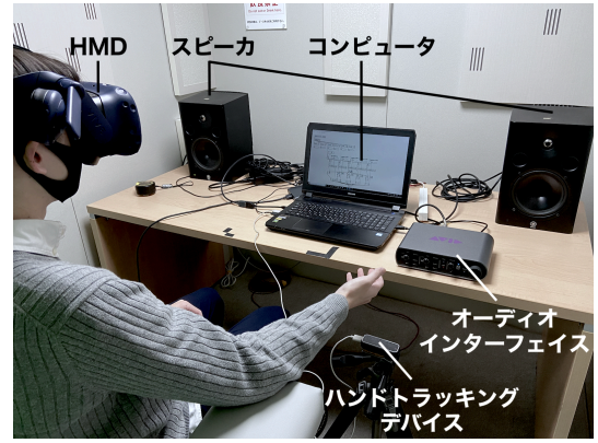
図 2 実験装置の概略図
