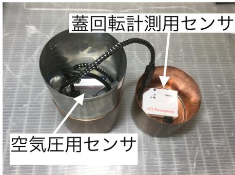
図 3 計測用茶筒の内部実装
