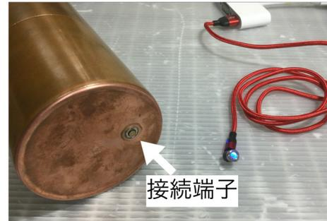
図 4 計測用茶筒の下面および配線実装
