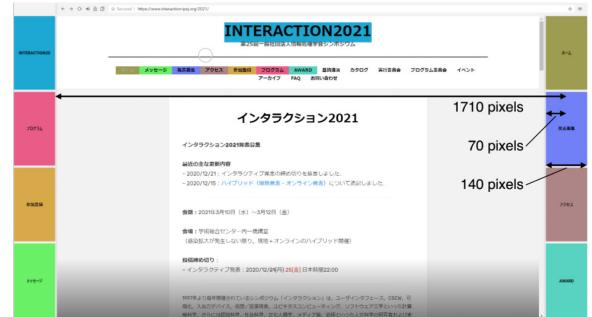
図 11 ActiGaze<sup>\*2</sup>の概要。1920 × 1080 pixels のディスプレイでは、70 pixels から 1710 pixels までの水平方向の視線移動が発生すると考えられる。
