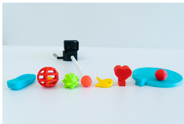
図 1 TeleStick Recorder と複数の異なる先端パーツ 左から、スプーン、カラカラ、トゲトゲ、デフォルト、指差し、ハート、ラケット
