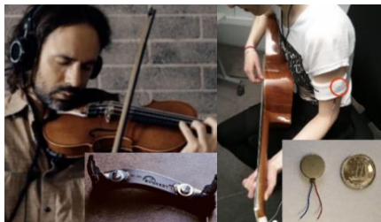
図7 楽器とそれぞれに適した振動子とその配置[6,7]
