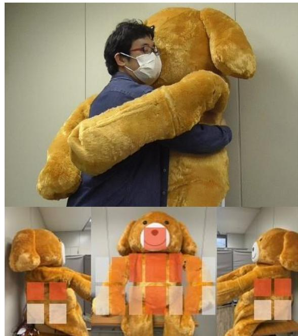
図1 ロボットとの抱擁している様子。上図のように抱擁すると、下図のように特定の位置のタッチセンサが反応する(赤色に濃くなるほど強く触れている)
