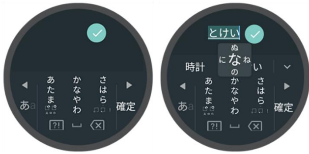
図 4. スマートウォッチにおけるテンキーフリック入力画面 (実物大) (2017 Google 日本語入力)
