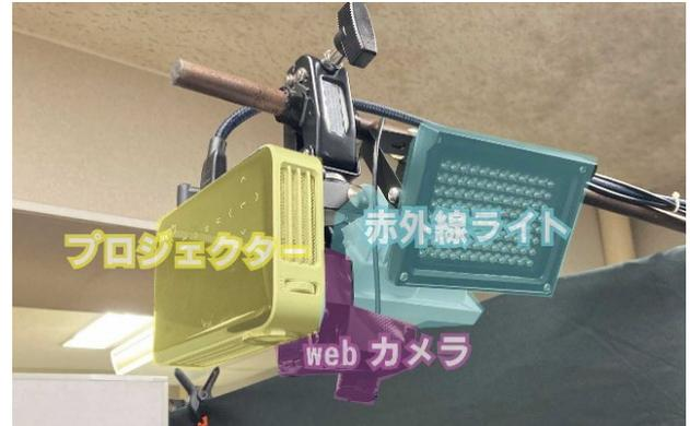
図 6 操作キャンバスの垂直真上のデバイス
