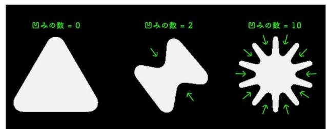
図3 凸性の欠陥の例
