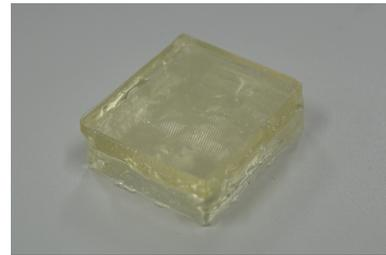
図 4: 試作した 2 層構造の飴製 2 面コーナリフレクタアレイ
