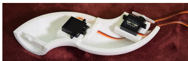
図2 四分円環体をモーターで連結した内部構造
