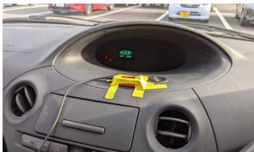
図3 予備実験で利用したセンサ&マイコン
