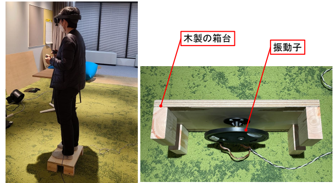
図6 VR体験の様子（左）と歩行振動提示装置（右）
