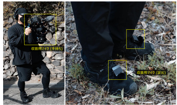
図 4 音声・歩行振動データ計測の様子 (左), 足元の拡大画像 (右)
