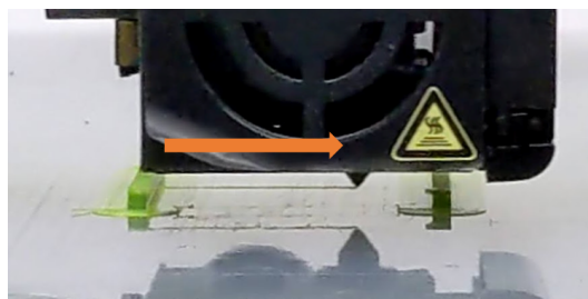
図 2 橋渡しして樹脂を出力する様子
