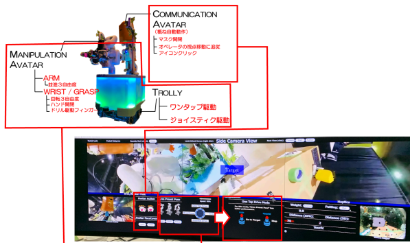
図 21 アイコンと小型ジョイスティックでの操作
