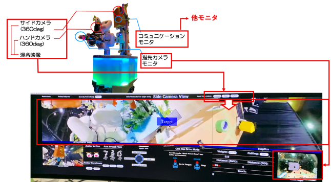
図 20 Avatar カメラのオペレータへの映像提示の例
