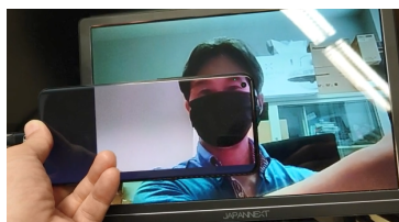
図 22 スマホと拡張モニターを利用した独自の視線一致技術
