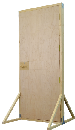
図 4 ドアノブ全体のプロトタイプの外観，中央のドアノブ部は取り外し可能である。
