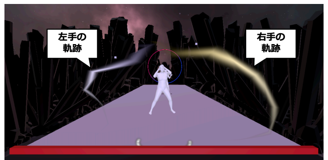
図 9 動作の軌跡の可視化の様子。図中の白色の線は左手の動作の軌跡を、黄色の線は右手の動作の軌跡を表している。
