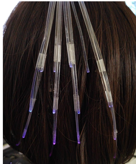
図 3 光ファイバーを利用した後頭部光源の試作
