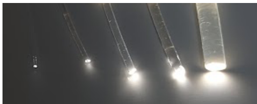
図 2 光ファイバーの太さと明るさの比較
