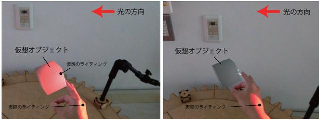
図 6 赤色の光が仮想オブジェクトに作用している様子。(左) ピコプロジェクタの光の範囲内に仮想オブジェクトを配置した場合、(右) ピコプロジェクタの光の範囲外に仮想オブジェクトを配置した場合
