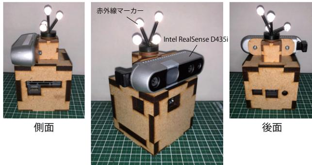
図 10 ピコプロジェクタと D435i、赤外線マーカー
