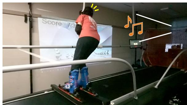
図 1 視覚障害者による実験の様子。視覚障害者は前方の映像を見ることはできないが、聴覚フィードバックによって仮想ゲレンデに配置された旗門を通過することができる。
