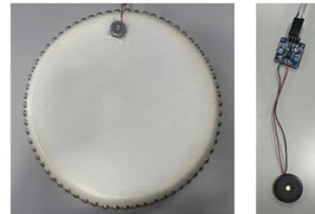
図6 振動センサを取り付けた太鼓(左)と振動センサ(右)
