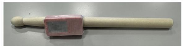
図8 加速度センサを取り付けたバチ
