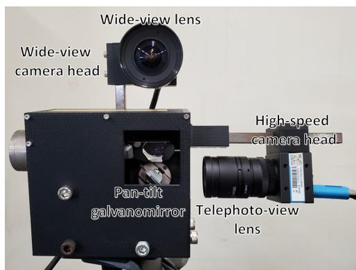
図 3: 超高速ミラー駆動パンチルトカメラを搭載したカメラモジュールの外観
