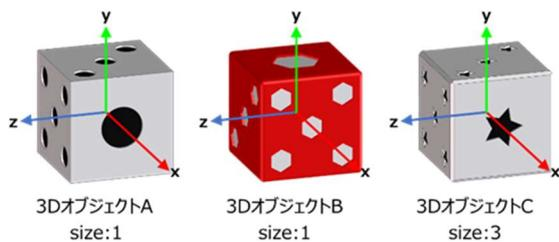
図2 3Dモデルデータのモデル座標系
