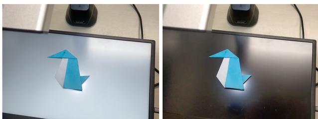
図 2 折り紙領域抽出のための輝度に変化する背景を用いた撮影システム
