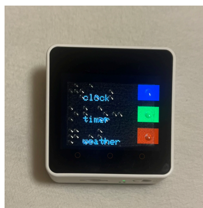
図 7 M5Stack Core2 に点字を印刷したフィルムを貼り付けた例
