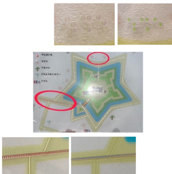
図 5 五稜郭公園の触地図案内板。「さくら」の点字とウォーキングコースのレンズに、色変化の仕組みを取り入れた。
