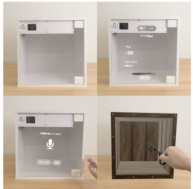
図 1 提案システムの動作イメージ。XR 空間において metaBox にインタフェースやテキストを表示し、ハンドジェスチャを用いてアプリケーションを操作する。画像は左上から、通常の metaBox、フリマ Box、対話 Box、宝箱 Box
