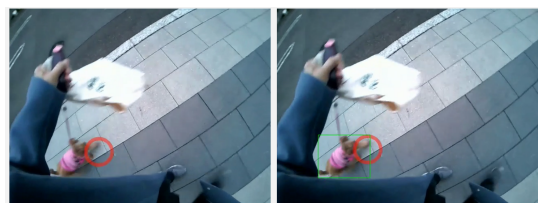
図 3 飼い主の視点動画から犬の領域を自動抽出しているフレーム画像の 1 例。(左が YOLOv8x, 右が訓練済みモデル。)
