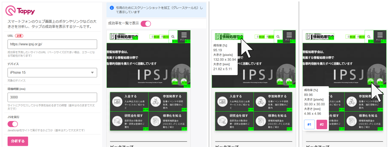
図 1 左：ウェブアプリ版 Tappy の画面構成。画面左側で分析対象の URL（ここでは https://www.ipsj.or.jp/ ）、対象デバイス、待機時間、JavaScript の実行の有無を設定してから「分析する」ボタンをクリックすると、画面右側に分析結果が表示される。分析画面ではタップ可能なボタンやリンクが矩形で囲まれ、タップ成功率が付記されている。矩形の色はタップ成功率（0～100%）に対応して赤から緑に変化する。中央：ある UI 要素をクリックすると、タップ成功率、大きさ（ピクセル単位、mm 単位）が表示される。画面解像度と PPI、およびスケール値によっては、要素のピクセル単位の大きさは整数にならないことがある。右：ページのトップ画像と、その画像を切り替えるためのボタン（矢印のアイコン）が重なっている。#1 をクリックするとトップ画像、#2 をクリックすると矢印アイコンの成功率と大きさが表示される。
